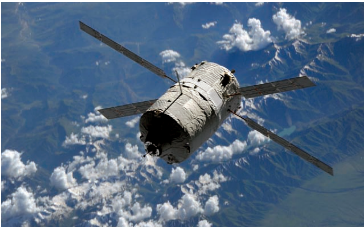
Il cargo ATV (Automated Transfer Vehicle) dell'ESA è in grado di portare fino a 7 tonnellate di rifornimenti alla Stazione Spaziale Internazionale. Una volta compiuta la sua missione rientrerà disintegrandosi nell'atmosfera. © ESA/NASA
