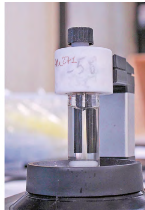
Reattore fotochimico stampato in 3D in acido polilattico (a sinistra). Reazione elettrochimica in corso con elettrodi di grafite (a destra).
