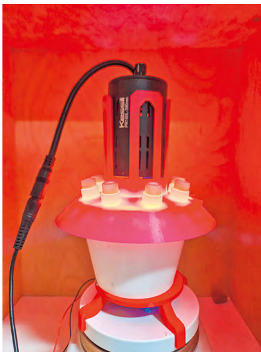
Reattore fotochimico stampato in 3D in acido polilattico (a sinistra). Reazione elettrochimica in corso con elettrodi di grafite (a destra).
