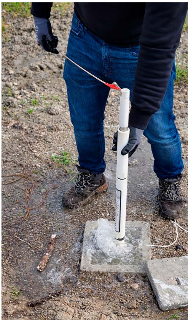
Carotaggio multiparametrico in piezometro in condizioni artesiane (Piana di Metaponto, Basilicata).
