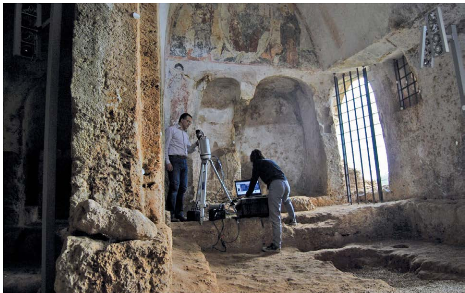
Scansione laser della Chiesa rupestre di Lama d'Antico (Fasano).
