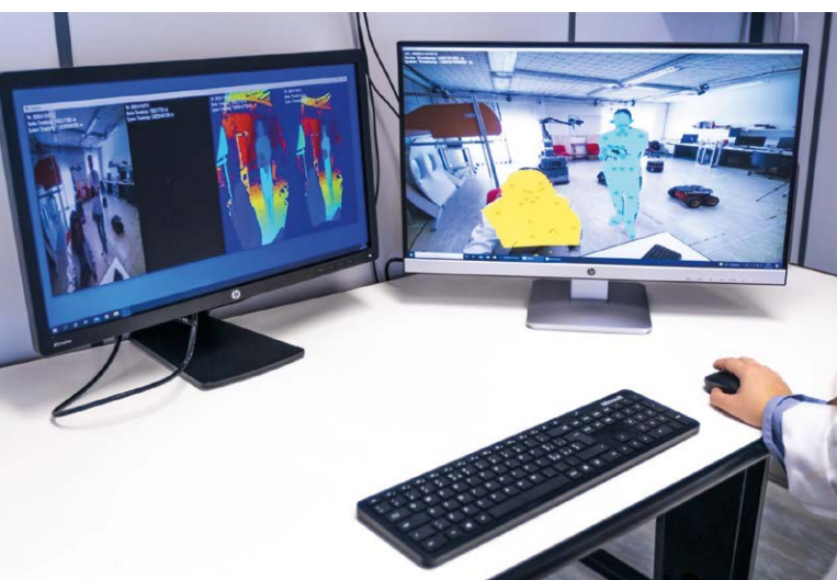
Analisi dell'ambiente 2D/3D con il riconoscimento degli operatori e identificazione della postura.
